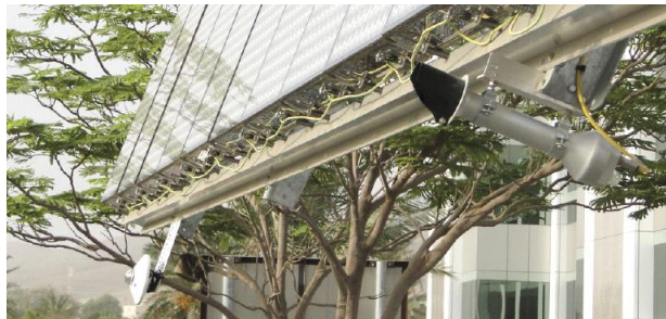
太陽を追尾しながら発電するCPVの評価に 直達日射計と全天日射計が使用されています。
