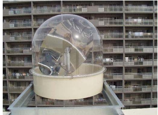
本器は太陽光を常に真下に導くようにミラーを自動制御するシステムで、二次ミラーを利用することで太陽光の届かない屋内や、高層ビルによる影などへ太陽光を導くことができます。
